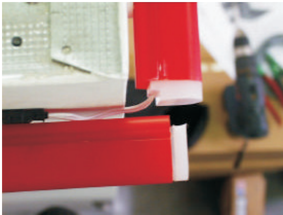
Außenecke mit einer 60mm breiten Lücke für Verlängerungen.
