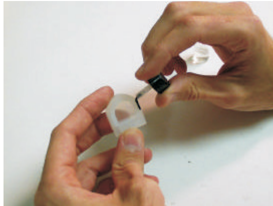
Tragen Sie die Grundierung auf die komplette Kante der Silikon Endkappe auf.
