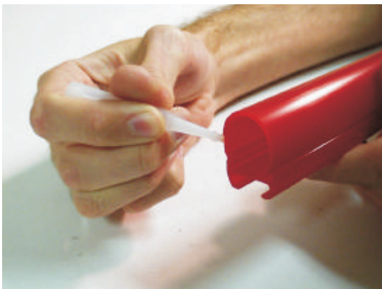
Tragen Sie den Klebstoff auf der Schnittfläche des LEDStripe Rohrs auf.
