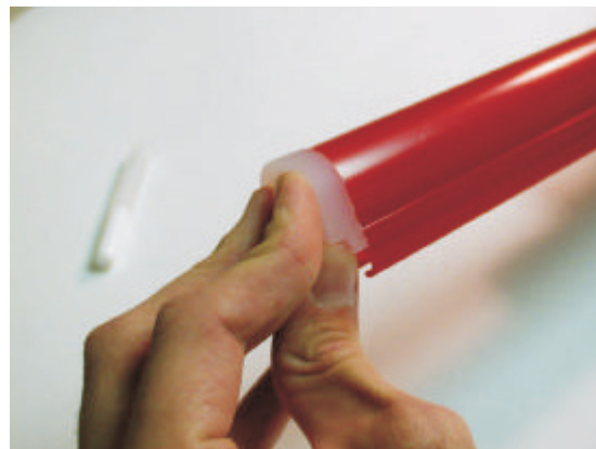
Drücken Sie die Endkappe ca. 30 Sekunden fest bis der Klebstoff angetrocknet ist.
